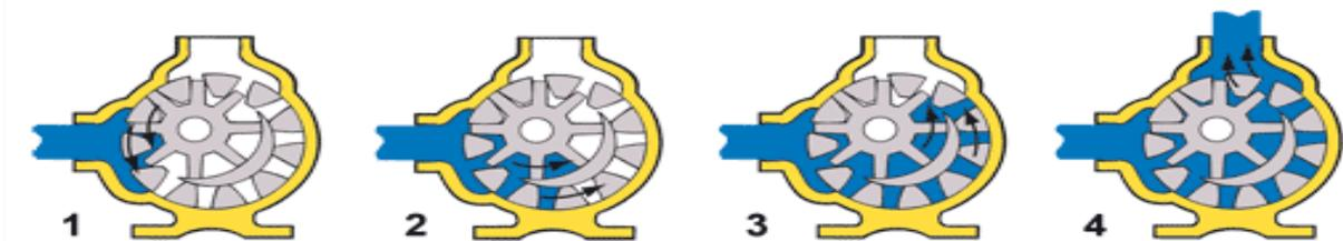
As bombas de engrenagens internas são bombas rotativas de deslocamento positivo, sendo que o fluxo é gerado por duas engrenagens, uma interna à outra separadas por uma meia-lua. Quando as engrenagens giram o líquido é transportado nas camaras criadas entre as engrenagens e a meia-lua. Quando as engrenagens se juntam, o líquido é forçado para fora da bomba. O resultado é um fluxo constante e suave do fluído da bomba de engrenagem, e uma alta vazão combinada com um tamanho compacto.
