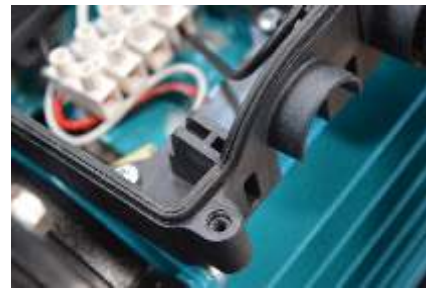
Caixa de ligação hermeticamente fechada
